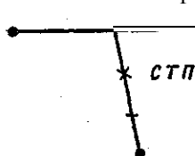
Рис. 52. Определение средней точки попадания по трем пробоям
